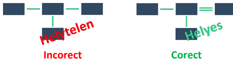
12- CAN-bus, ramificare incorectă și soluție cu două fire
