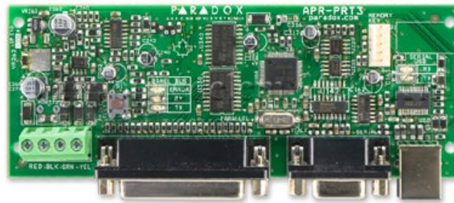
34 – Modul de integrare și de imprimantă Paradox APR-PRT3
