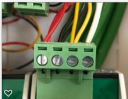
14 - O conexiune tipică CAN
